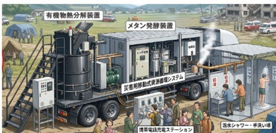
IEC 社 災害用移動式資源循環システム（有機物熱分解装置＋メタン発酵装置）
